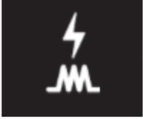
此图标指示控制器电缆插头的所在位置。控制器电缆同时具有电源线和 I/O。
